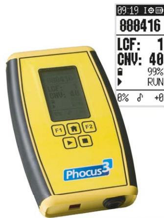
Komunikátor zobrazuje faktor pravděpodobnosti úniku (LCF) a kritickou hodnotu zvuku (CNV), umožňuje také přímý odposlech poruchy
