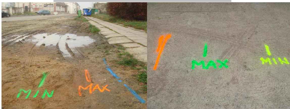
Obr.22 Určení správné polohy vedení při rozdílné indikaci režimu maxima a minima (vlevo modře, vpravo oranžově)
